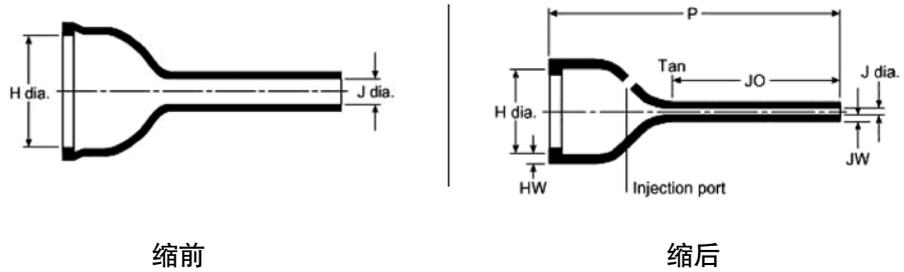
为电缆接头和瑞侃接头后附件提供电缆线束的应力解除。主要用在小直径的电缆连接处，能满足高比例的接头和线缆直径。
